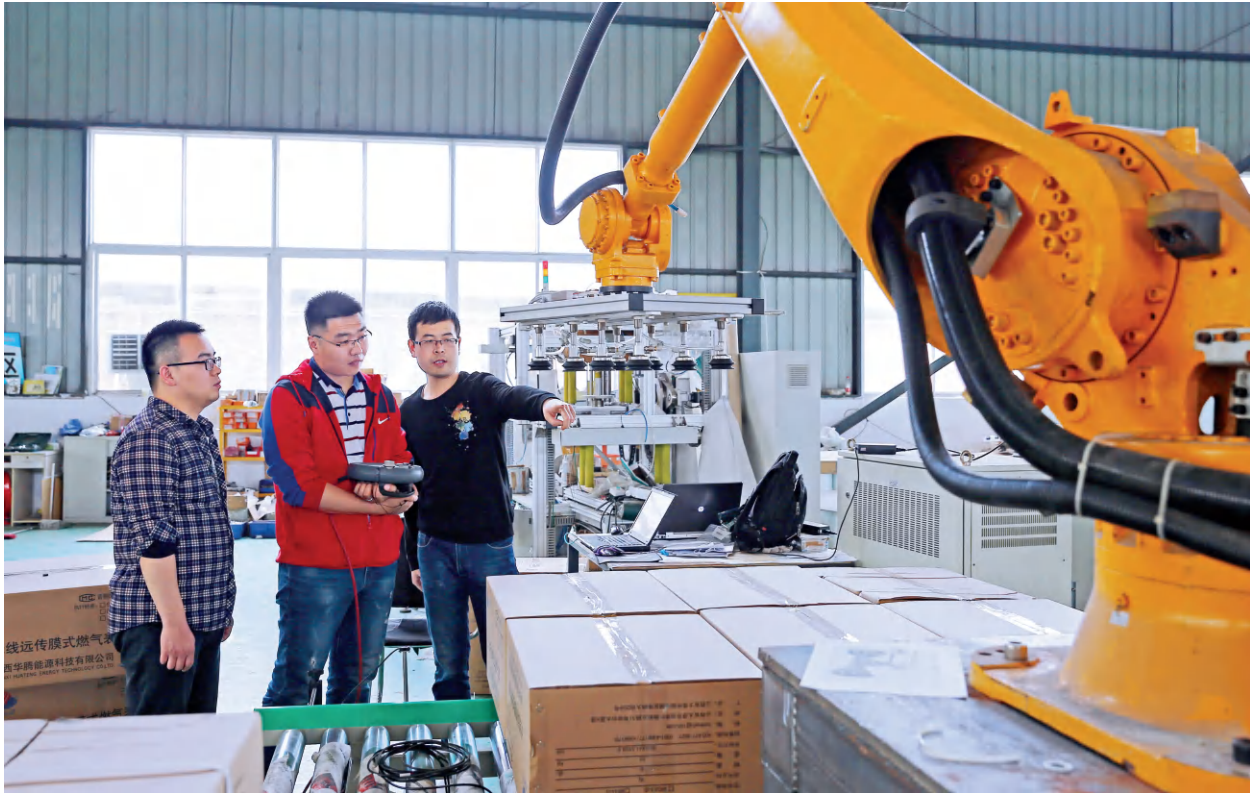
四川德阳，技术人员正在对机器臂进行编码调试。
