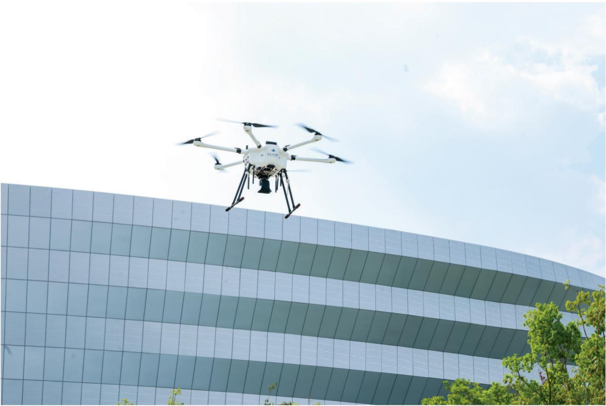
氢能应用场景广泛，“海陆空”齐备。图为我国研制的全球首款氢能无人机“天目山一号”。
